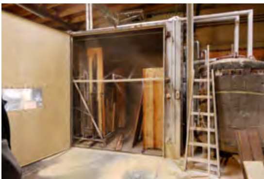
Bild 4: Statt Tauchbad - Düsen erzeugen hier einen feinen Sprühnebel, der den Lack anlöst und teilweise schon abschwemmt.
